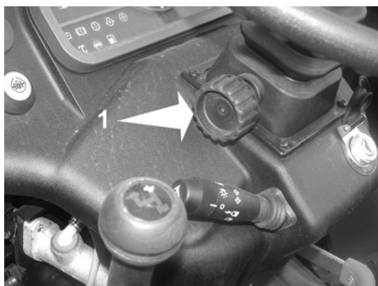
Agroplus S (sans inverseur) Réglage du volant 1 - Pommeau réglage du volant en hauteur.
